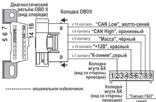
Рис.4 Схема подключения БК «ШТАТ 219 X6».
