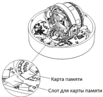
Рисунок 2-3 Установка карты памяти (камера I типа)
