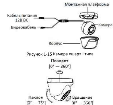
Рисунок 1-16 Настройка угла наблюдения камеры
